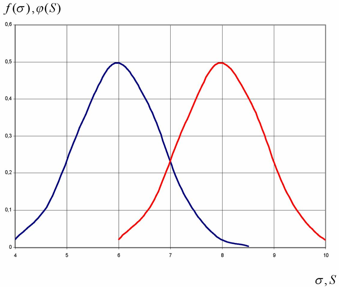
Рис.1.2. Плотности распределения действующих и предельных напряжений
