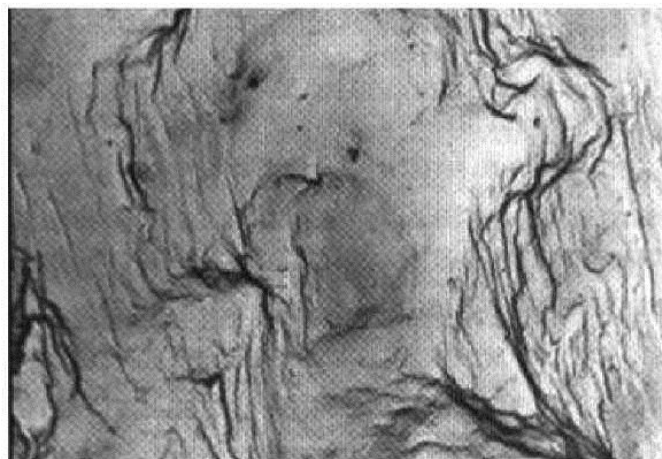
Рис. 2.79. Плато, окруженное усталостными бороздками. \times 4000
