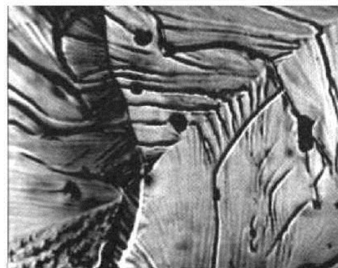
Рис. 2.54. Схема разрушения путем раскалывания отдельных зерен ( а ) и реально разрушенные зерна ( б )
