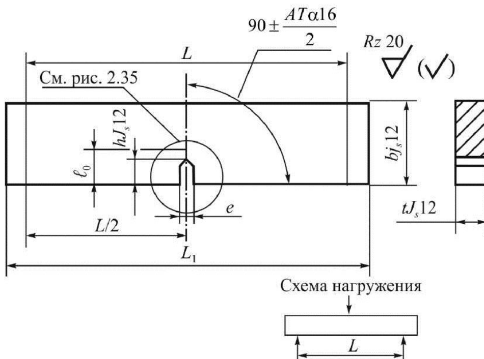
Рис. 2.34. Образец типа 4: L – расстояние между опорами, L = 4b , b = 2t , \ell_0 = (0,45-0,55)b , h = (0,35-0,50)b
